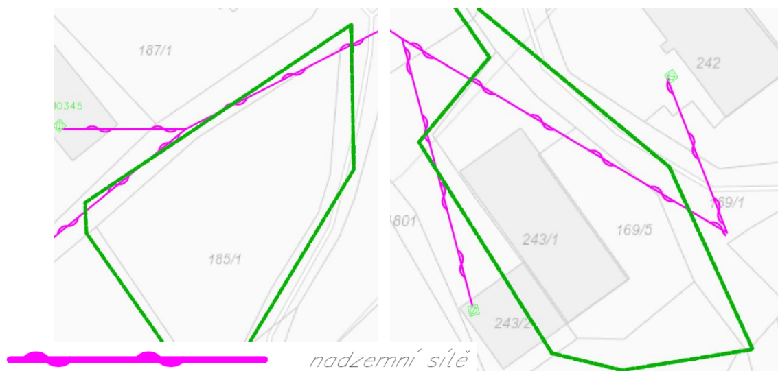
Obrázek 10: situační zakres telekomunikace
